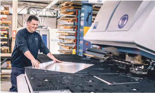
MASSARBEIT: Ein Mitarbeiter entnimmt zugeschnittene Blechteile aus der Stanz-Laser-Kombination.
