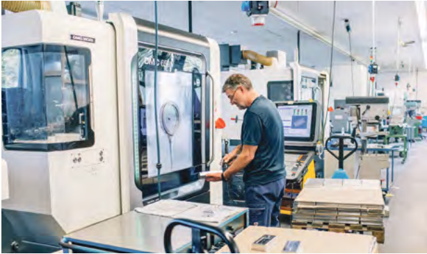
FERTIGUNG: In diesem Arbeitsschritt werden in der Maschinenhalle mechanische Bauteile gefräst.
